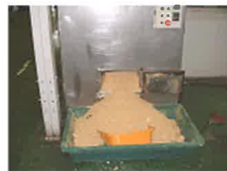
回収された生ごみは、大型生ごみ処理機で高速発酵処理します。
